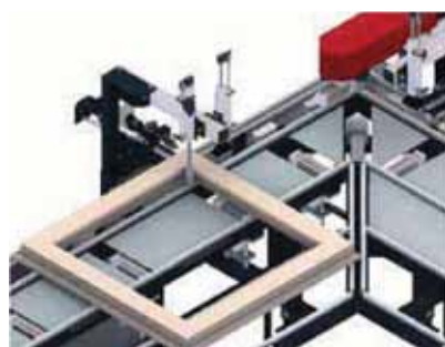
Unità di foratura per cerniere angolari 2 screwing units with automatic turning device
